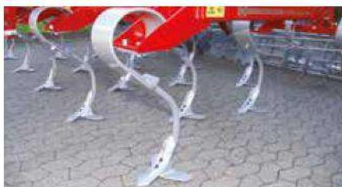
Dents VibroFlex Mixing avec soc Mixing.
