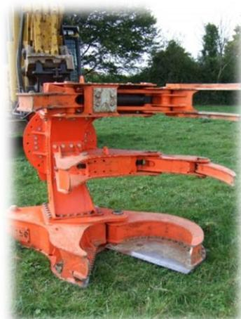
Avec l'utilisation du grappin coupeur sur pelle, le rendement est 5 à 8 fois plus rapide qu'avec une tronçonneuse. Ce matériel limite la pénibilité du chantier lors de l'abattage, il permet d'obtenir une plus grande sécurité du personnel. Son impact sur le terrain, même humide, est limité grâce à la présence de chenilles. Le bois peut être entassé en andain, ce qui permet une manipulation optimale et un gain de temps.
