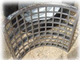
L'utilisation de plaquettes pour de la litière ou pour des chaufferies de petite puissance nécessite des plaquettes de petites dimensions, produites avec des grilles de calibrage de 30 mm.
