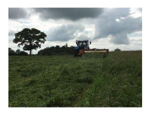
Les volets d'éparpillement permettent d'étaler le fourrage sur la largeur de la faucheuse et ainsi de l'exposer au maximum au soleil et à l'air (photo CA58)
