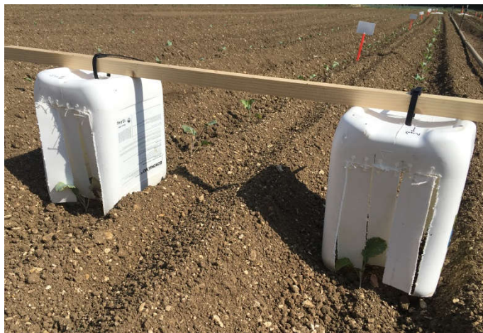
Piège à glu expérimental avec volets mobiles
