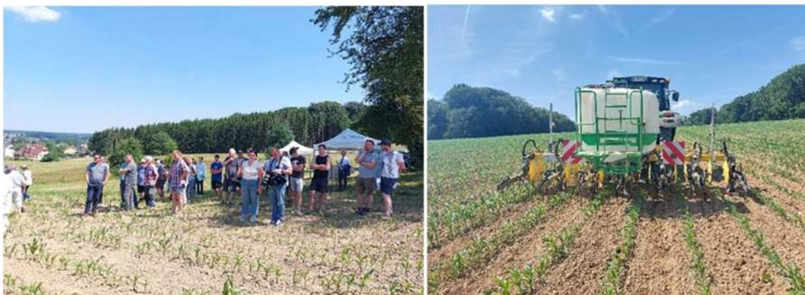
La machine présentée est une désherbineuse haut de gamme, avec système de guidage par caméras et terrage forcé, qui permet un travail de précision.
