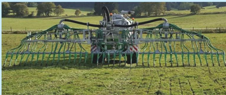
Les pendillards permettent de limiter les pertes par volatilisation ammoniacale (favorisées par le vent et les températures élevées), de mieux valoriser le lisier et de limiter ainsi l'usage des engrais minéraux azotés.
