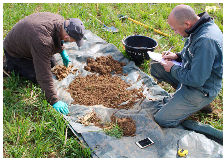
Lorsque le bloc est sorti avec le «test bêche», chaque élément (mottes, cailloux, racines) qui le compose est séparé par Habib et Pascal (à gauche) et évalué en proportion. Les vers de terre sont mis de côté pour l'identification des espèces.
